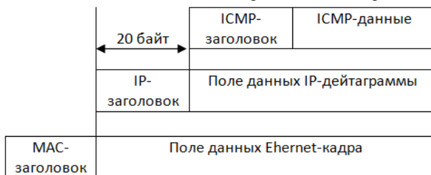
Рис. 3.8 - Схема вложения ICMP-пакетов в Ethernet-кадр
