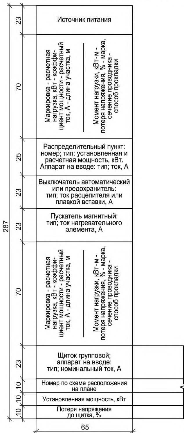
Ф о р м а 4 — Боковик принципиальной схемы питающей и распределительной сетей
