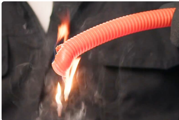
Рис. 2. Воздействие огня на гофру из ПНД
