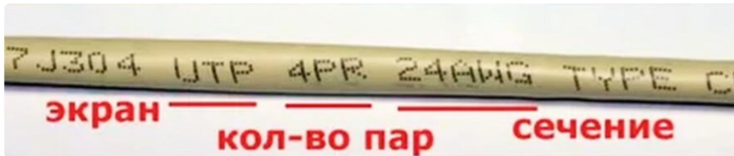
Рис. 1. Маркировка сечения кабеля по нормативу AWG
