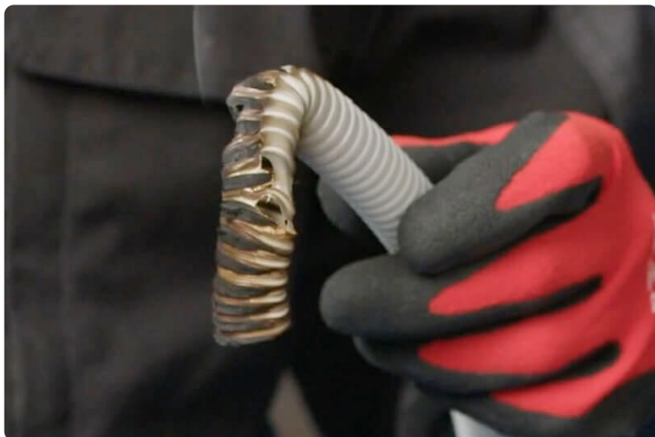
Рис. 1. Воздействие огня на гофру из ПВХ
