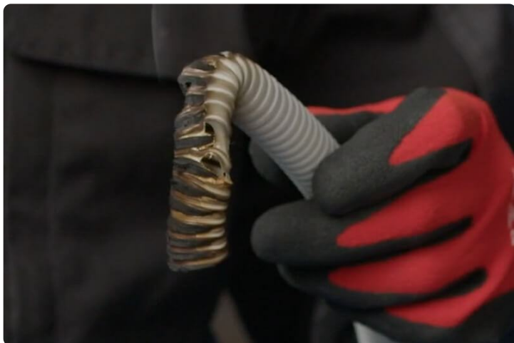
Рис. 1. Воздействие огня на гофру из ПВХ
