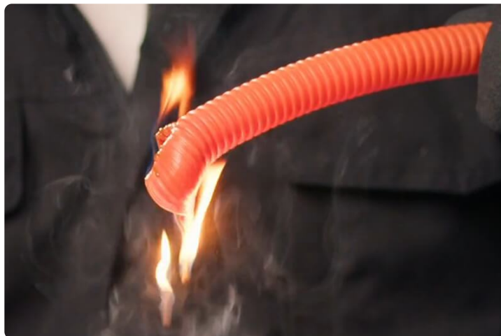
Рис. 2. Воздействие огня на гофру из ПНД
